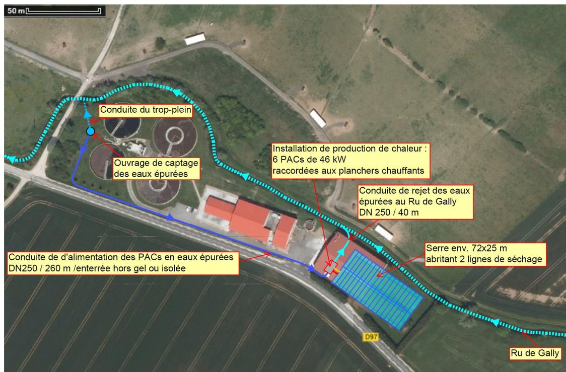
**Emplacement prévisionnel des éléments de l'installation de séchage combiné**
