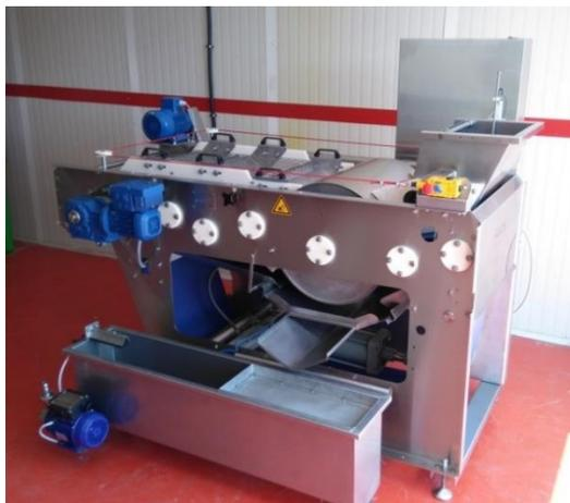
Des bandes permettent d'écraser les pommes déjà râpées et le jus est récupéré dans le bac de réception alors que le marc peut être récupéré dans un palox. Les pressoirs ont des capacités de tonnes/h, ainsi le choix se fait selon le volume transformé et la période. Une pompe de transfert permet de transférer le jus du bac de réception aux cuves.
