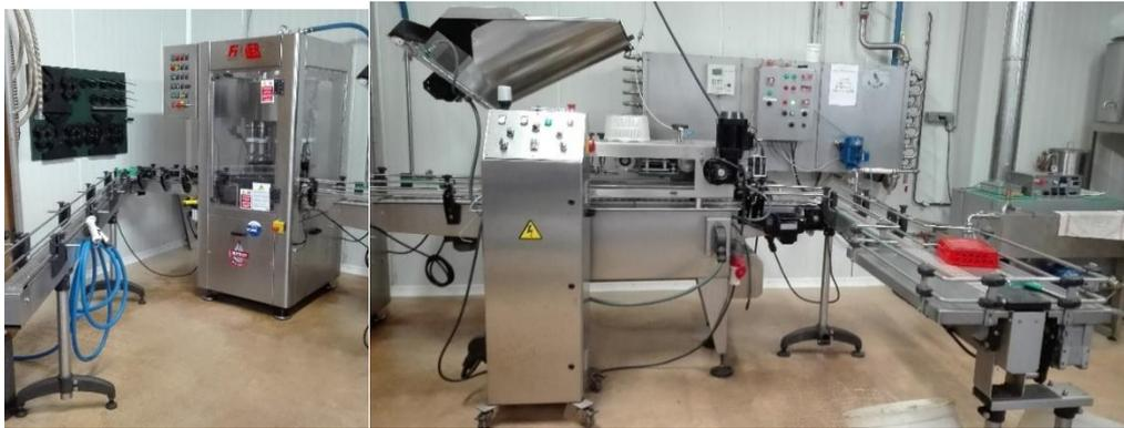
Les bouteilles doivent ensuite être stockées, il faut retourner les bouteilles pour pasteuriser le bouchon, et ensuite les ranger.
