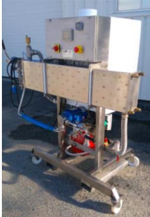
Une fois que le jus est chauffé par le pasteurisateur, il peut être embouteillé.
